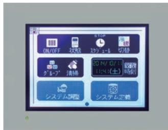
通信中継器DTS-MB5を介して、パワーユニットの状態監視、遠隔操作を行います。
