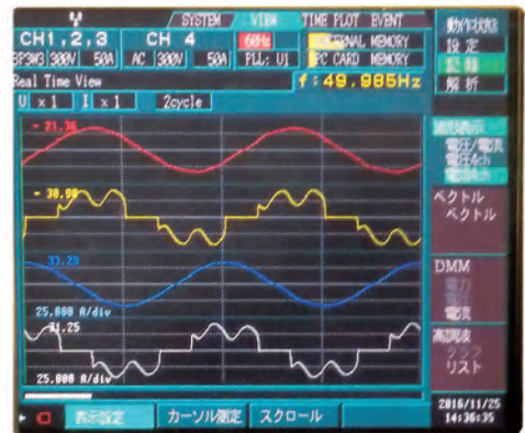
*アクティブフィルタを通した波形の例
