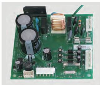
DCモータ制御・電源基板
