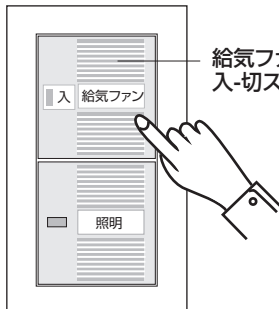
給気ファン・照明スイッチ
